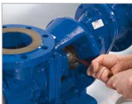
5. Reculez la bague de projection et retirez la goupille de l'arbre à broche
