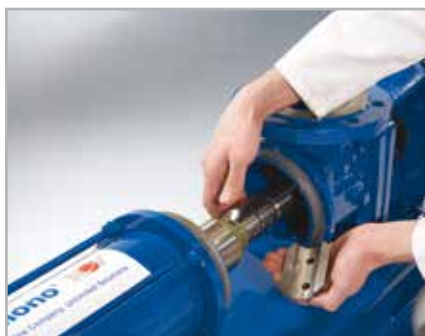
2. Déposez les deux demi-coquilles de l'accouplement rapide de bielle
