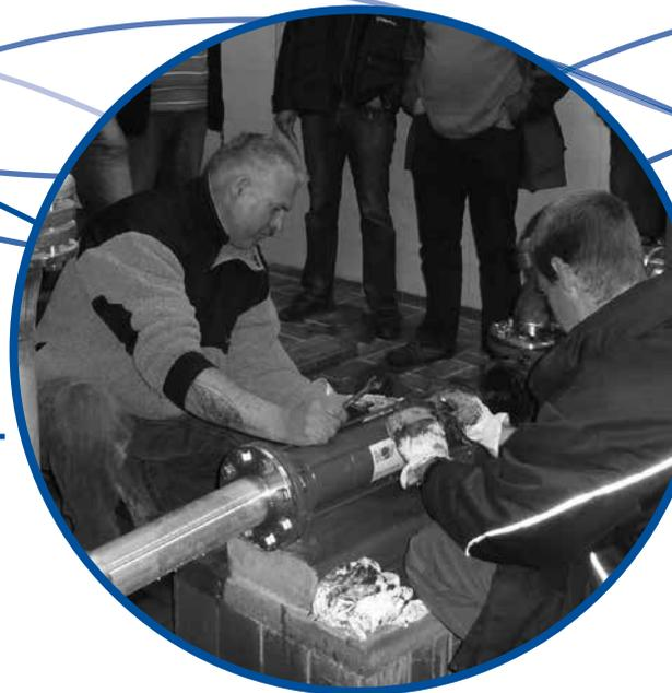
Die Möglichkeit, den für eine durchschnittliche Wartung benötigten Zeitaufwand von fast einem Tag auf 1 Stunde zu reduzieren, war einer der Hauptgründe, warum man sich in einer Kläranlage in Ostholstein für eine im eingebauten Zustand zu wartende EZstrip™-Exzentrerschneckenpumpe von NOV Mono entschied.
