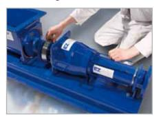
5. Tournez la chambre d'alimentation ainsi que le rotor et le stator pour les fixer en place
