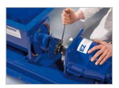
4. Dévissez les barres d'accouplement et tirez l'ensemble de la barre d'accouplement à l'écart de la bride de décharge
