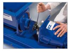
6. Desenrosque el rotor del estator.
