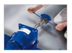
Desenrosque las barras de anclaje y tire del conjunto de la barra de montaje para separarlo de la brida de descarga.
