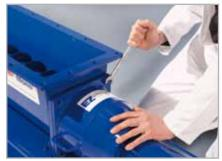
2. Retire la cámara de alimentación para permitir pleno acceso al área de la junta de pasador con el fin de eliminar atascos o torta apelmazada.
