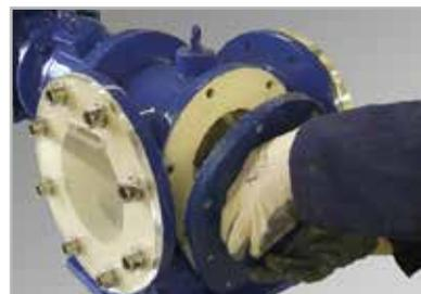
**4. Wellenmuttern lösen und entfernen**
