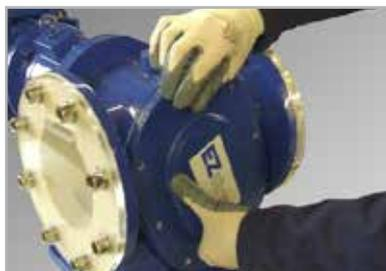
**3. Große Zugangsabdeckung abnehmen, für eine Sichtprüfung der Messer**
